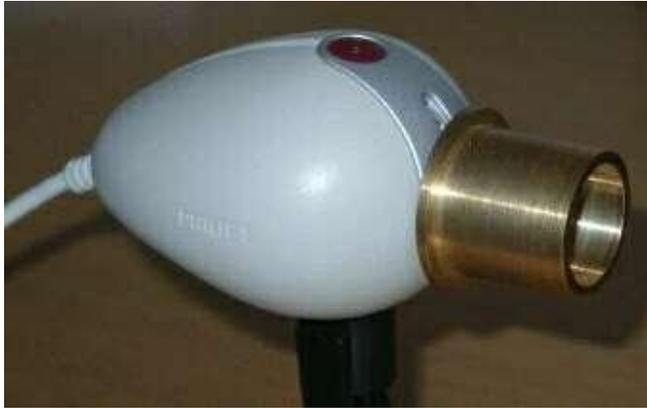
WebCams sind die einfachste und billigste Art, den Mond zu photographieren. Für ca 150.– bekommt man eine WebCam, die an einem Fernrohr gute Aufnahmen ermöglicht.
